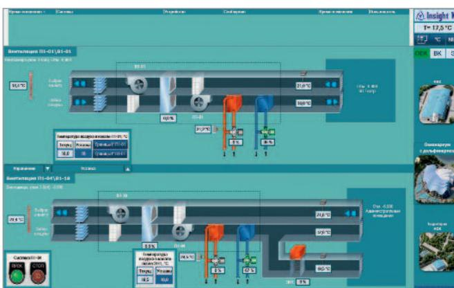
**Рис. 4. Пример мнемосхемы системы вентиляции**
