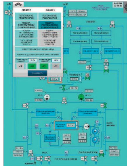
**Рис. 6. Мнемосхема мониторинга системы водоподготовки на сенсорной панели**
