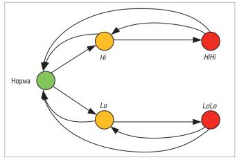
Рис. 2. Диаграмма изменения состояний аналогового аварийного сигнала
